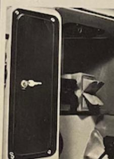
Selbstverständlich ist das Handschuhfach beleuchtet. Im Handmurdrehen machen Sie aus der Fächbeleuchtung eine am Bordnetz angeschlossene Handlampe.
