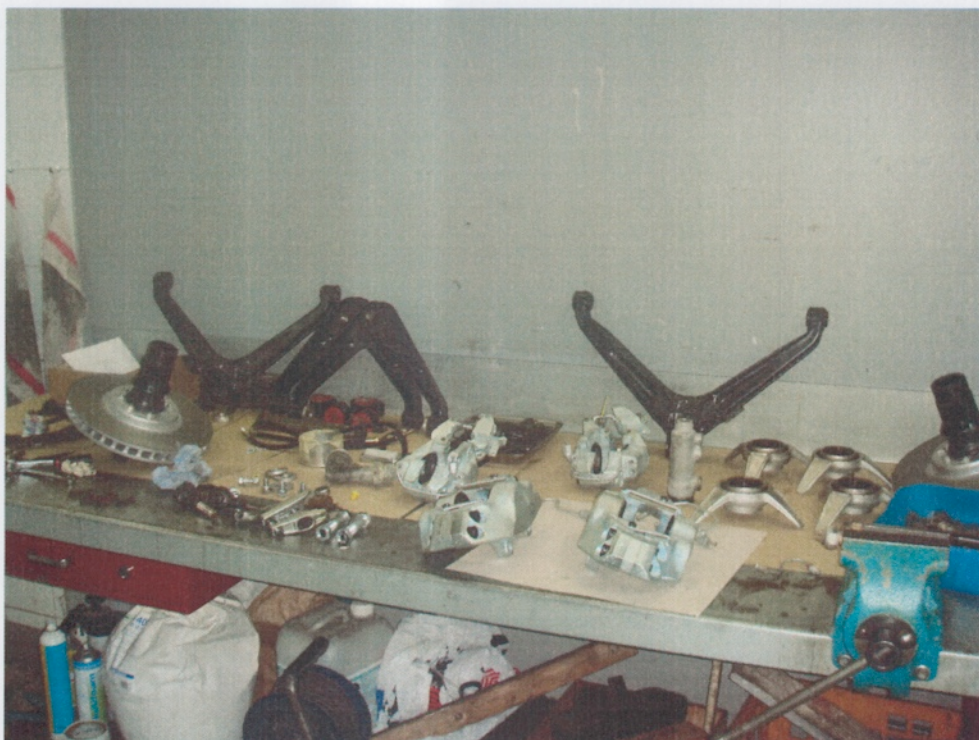
Zerlegung und Revision der Achsen und Bremsanlage
