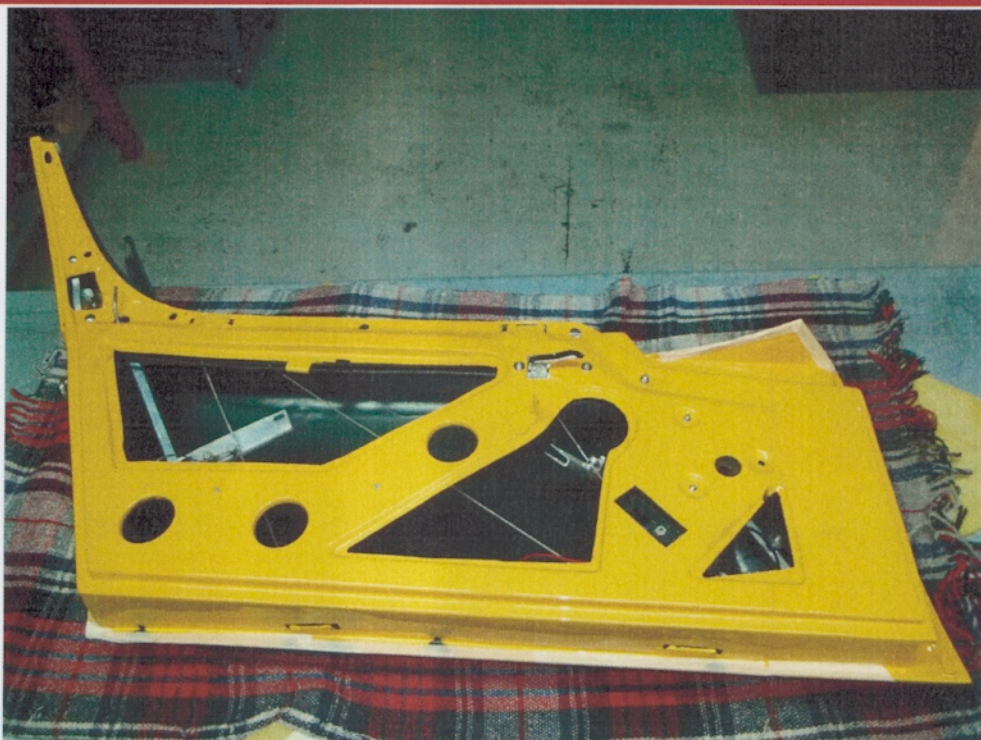
Vormontage der Türen und Scheibenheber- Mechanismus
