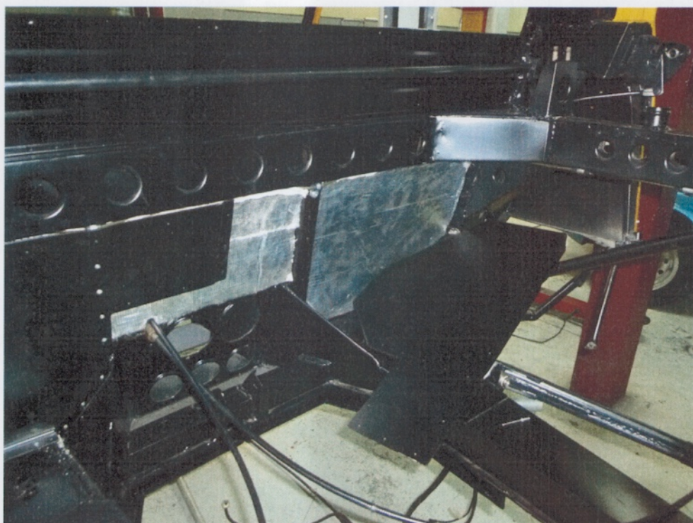
Isolation der Rückwand und anpassen der Panels
