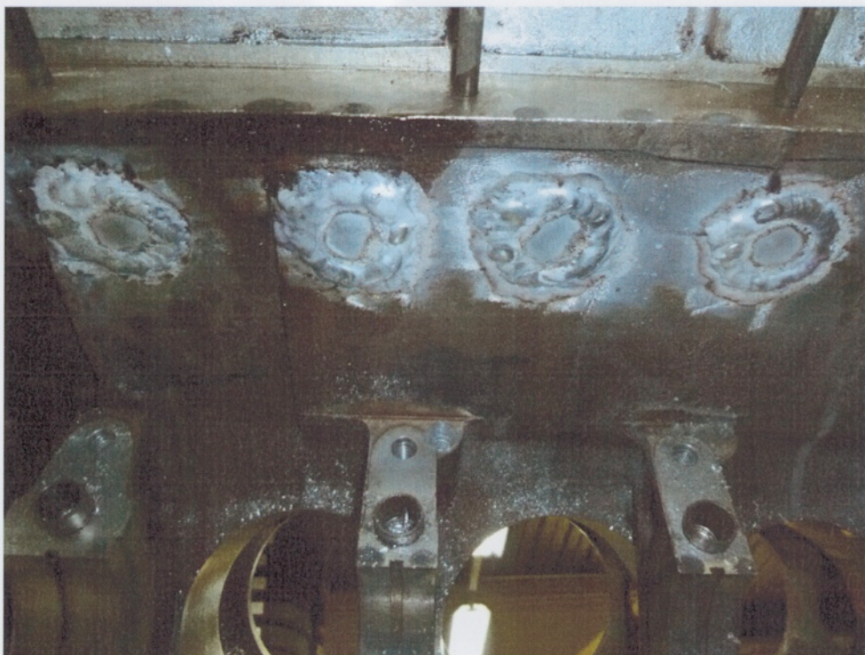
Umbau des Getriebes auf getrennte Schmierung wie SV-Modelle
