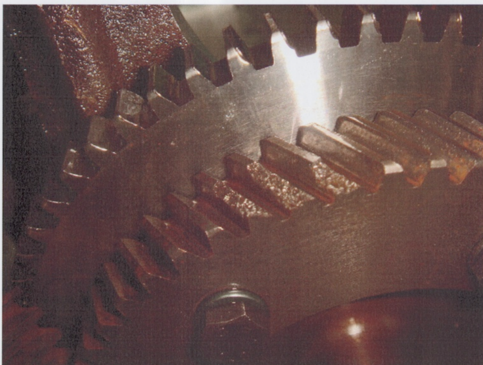
Abgebrochene Zähne im Bereich Nockenwellentrieb
