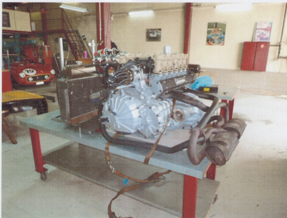
Fertig montierter Motor bereit zum Probelauf
