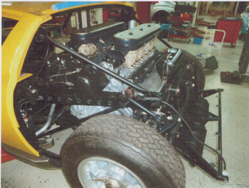
Motor fertig eingebaut und eingestellt
